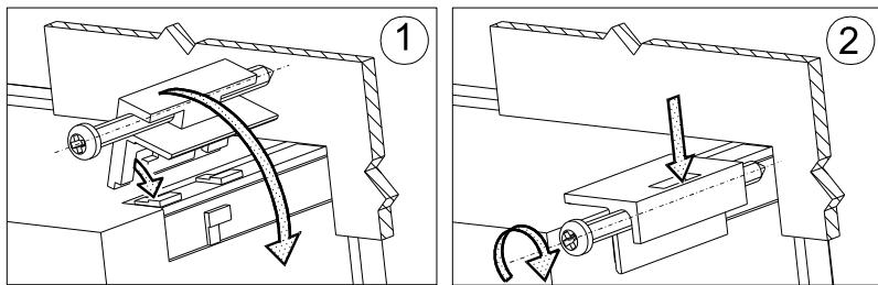
Fig. 2. Meter fitting
