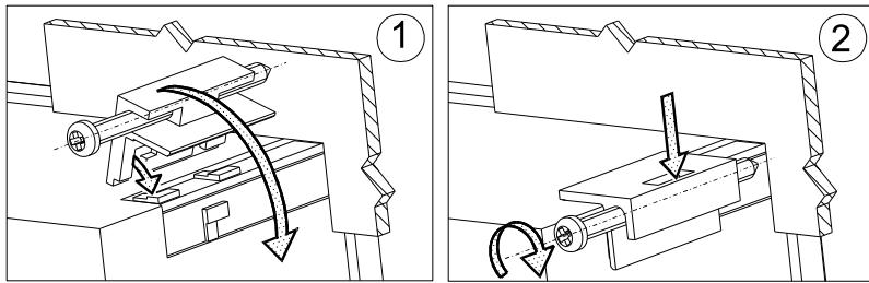
Fig. 2. Meter fitting
