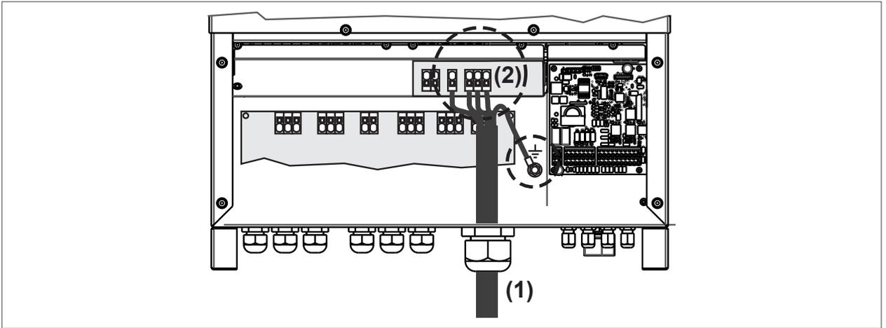
Figure 17 : AC connection (PVSA-EE-... models)
