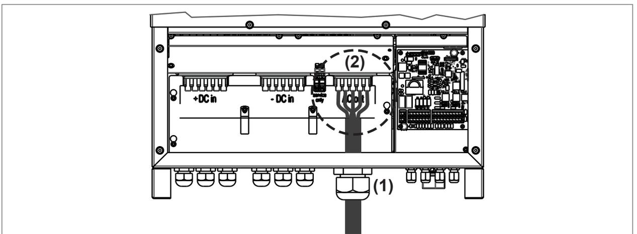
Figure 16 : AC connection (PVSA-AE-... models)
