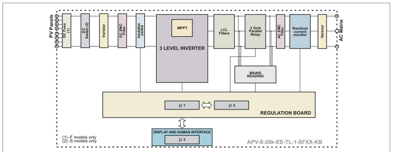
Figure 7 : Block diagrams PVSA-EE
